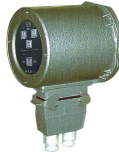
● 调零位：按关向键至阀门全关位置，行程 S3 动作（闭合），随后同时按下停止键和切换键约 3 秒，此时数码管显示 HL，放开停止键和切换键后，按关键，这时反馈电流变为 4mA，零位调整完成。
