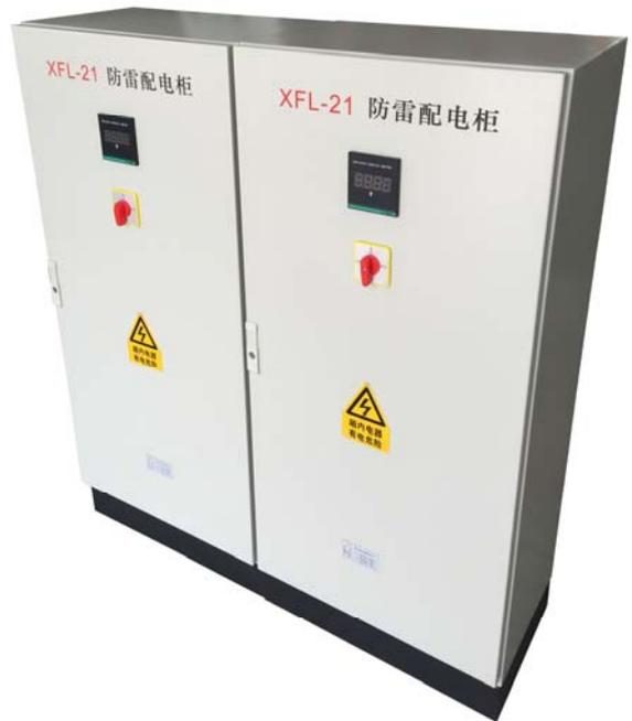
电源柜输入形式分为单相 220V 和三相 380V，接入方式分为并联或串联，设计容量<50Kw，可根据用户需求，配置交流净化电源或 AC/DC 直流电源模块，柜体为 MS 型，单开门结构，内有照明灯具，受门开关控制，柜门打开时点亮，方便用户检修；外形尺寸为（宽\*深\*高）600\*400\*1200mm，尺寸根据不同配置变化；前门安装有交流数显电压表和电压转换开关，直观显示输入进线电压，方便用户读取；
